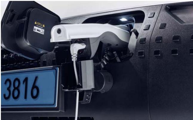
실외 V2L(Vehicle to Load) 커넥터
