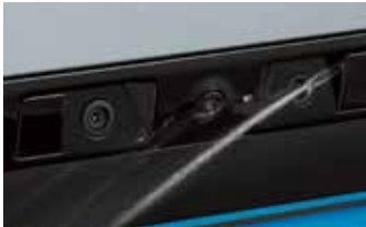
3종 카메라 클리닝 시스템: 후방 모니터, 디지털 센터 미러, 빌트인 캠 2
