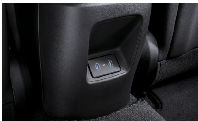
USB-C 충전기(1열 1개, 2열 2개) 차량에 USB 충전포트를 장착하여 앞좌석과 뒷좌석 승객의 모바일 디바이스 충전이 용이하도록 하였습니다.
