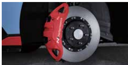
N 퍼포먼스 브레이크 시스템 (모노블록 4피스톤 캘리퍼, 볼팅타입 하이브리드 디스크)
