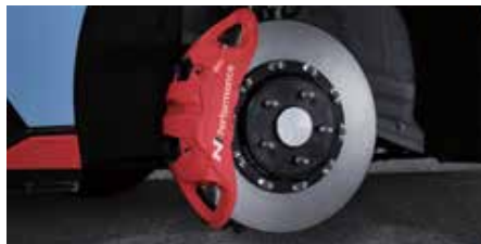
N 퍼포먼스 브레이크 시스템 (모노블록 4피스톤 캘리퍼, 볼팅타입 하이브리드 디스크)
