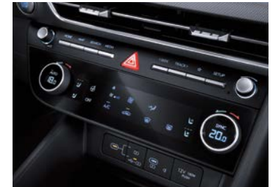
파노라믹 커브드 디스플레이/ 클러스터(12.3인치 컬러 LCD) 듀얼 풀오토 에어컨(미세먼지센서/공기청정모드/ 오토 디포그/애프터 블로우 포함)
