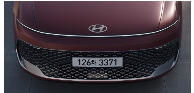
수평형 LED 램프(심리스 호라이즌 램프 - 주간주행등, 방향지시등, 포지셔닝 램프)
