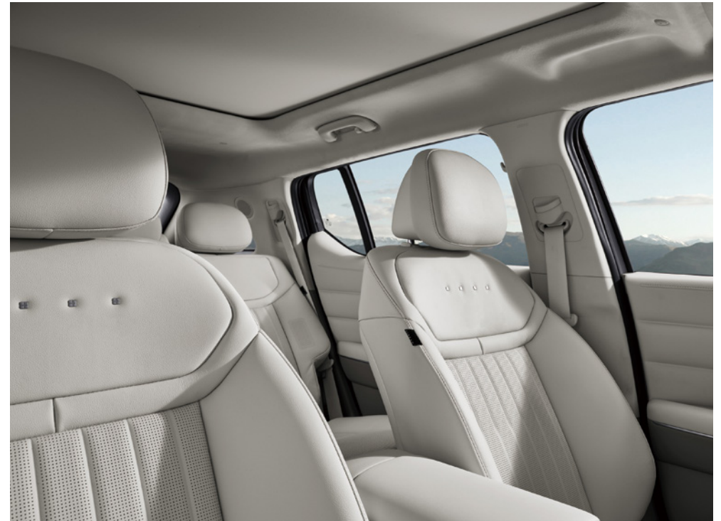
바이오 프로세스 천연가죽 시트(메탈패처 적용, 엠보싱 디자인 편칭), 리사이클 PET 스웨이드 내장재(헤드라이닝/선바이저)
