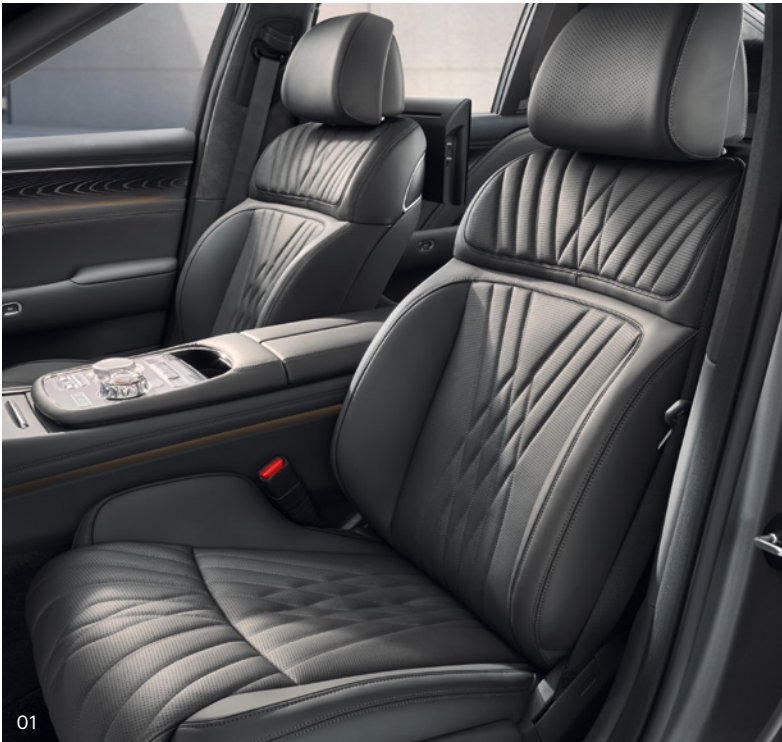
01. 에르고 릴렉싱 시트 _ 시트백 10개 포켓과 쿠션 2셀 구조를 활용하여 전신 모드 외 3가지의 마사지 모드를 제공합니다. 주행 속도나 뒷좌석 원스텝 특화 모드, 무드 큐레이터 등의 조건과 연동되는 공압시스템으로 최적의 착좌감을 제공합니다.
