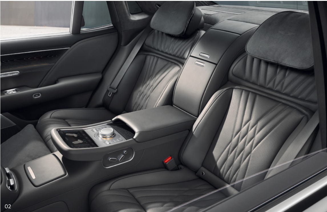
02. 퍼스트 클래스 VIP 시트 _ 좌우 독립, 슬라이딩 연동 리클라이닝이 가능한 뒷좌석 시트는 눕힘 각도와 틸트 거리를 최적화하고 레그레스트와 풋레스트의 연결형 구조를 적용해 장시간 운행에도 안락한 착좌감을 선사합니다.
