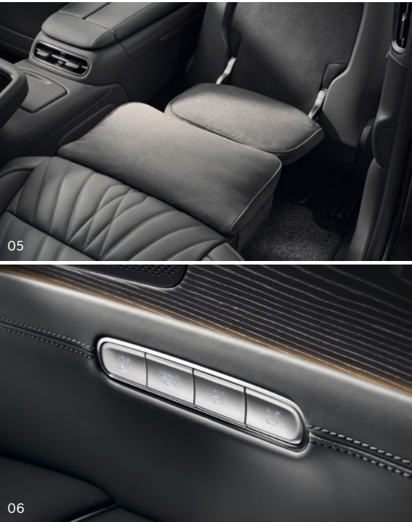
05. 06. 레그레스트 & 풋레스트 _ 연결형 구조의 레그레스트와 풋레스트가 더욱 편안한 착좌감을 제공합니다. 열선이 적용된 풋마사지 기능으로 사계절 내내 쾌적한 온도에서 발의 피로를 풀어줍니다. 원스텝 특화 모드 통합 스위치 _ 통합 스위치를 조작해 뒷좌석의 개인 맞춤 환경을 원스텝으로 조절할 수 있습니다.
