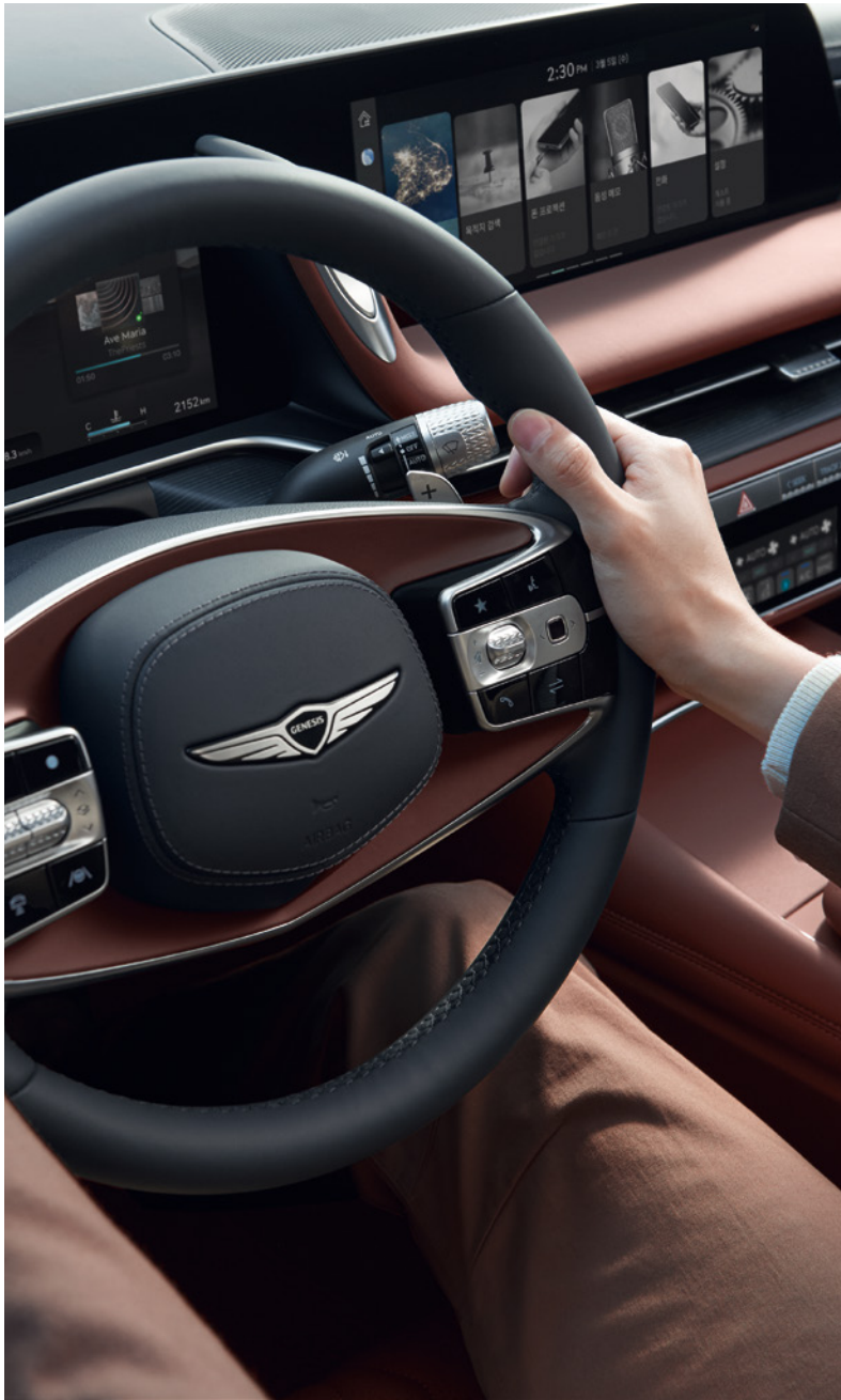
직접식 그립 감지 시스템 _ 손이 스티어링 휠 표면에 닿았을 때, 정전용량의 변화를 감지하여 그립을 판단하는 기능입니다. 휠을 가볍게 터치해 첨단 운전자 보조 시스템의 일부 경고음을 해제할 수 있습니다.
